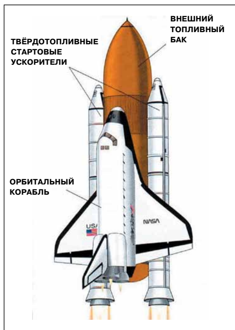
Компоновочная схема космического корабля многоразового использования Space Shuttle.
